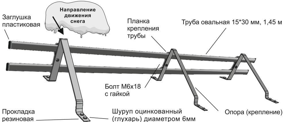
«Кровельный центр» предлагает элемент системы безопасности кровли - трубчатый снегозадержатель, который используется во избежание лавинного схода снега с крыши весной и во время оттепелей. Трубчатый снегозадержатель имеет антикоррозийную защиту и подходит для любого вида кровли. Опоры изготавливаются из стали сечением 4x25мм, а трубы имеют толщину стенки 1,2мм и сечение 15x30мм, что придает особую прочность и эффективность системе снегозадержания.
